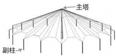
▲大正時代の無線塔の傘型アンテナ
